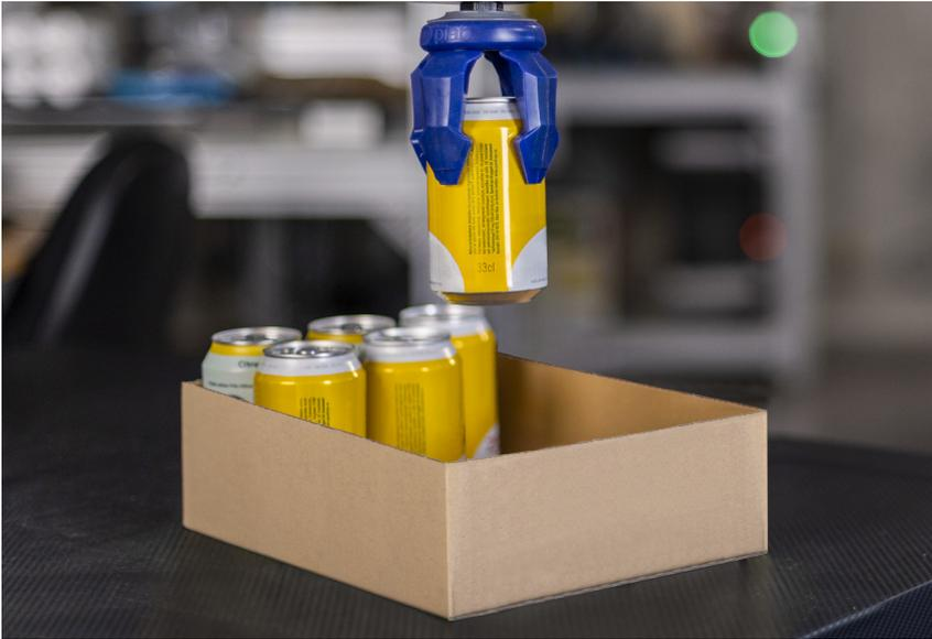
Piabは、食品業界での使用を想定して、大型モデルpiSOFTGRIP® 100-4を新たに開発しました。食品だけでなく、不揃いな形状の機械部品、射出成形部品の取り出しなどにも使用できます。
